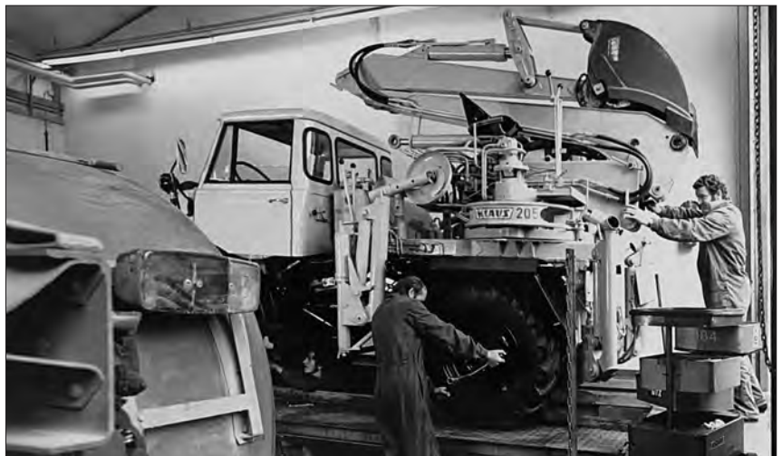
Werkstatt von Henne – die Monteure arbeiten an einem 406 mit Klaus Aufbau-Bagger
