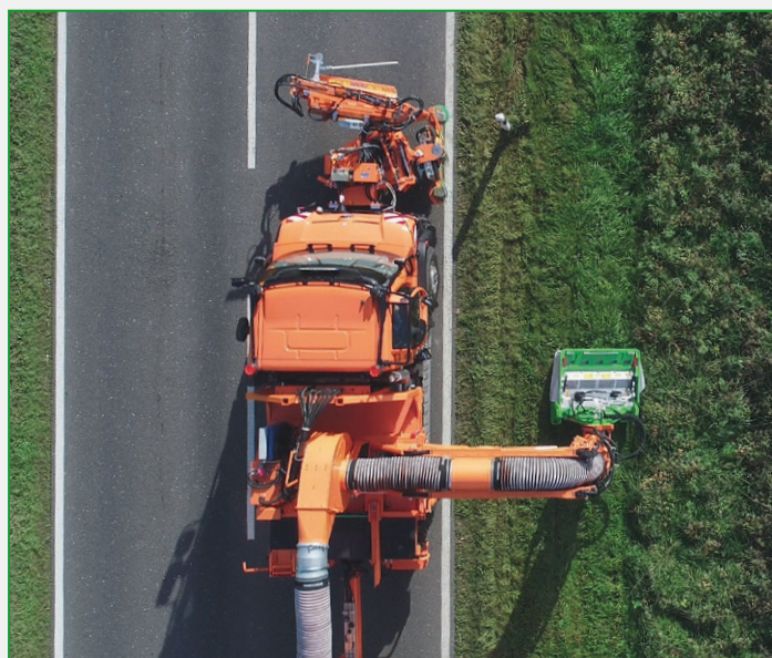
Kombinationseinsatz mit Schlegelmähkopf für den Intensivbereich
