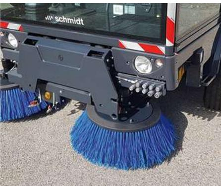
Ein flexibles Kehrsystem garantiert in jeder Situation ein sauberes Ergebnis. Das gezogene, vor der Vorderachse montierte Tellerbesensystem hat eine Kehrbreite von 2.200 mm.
