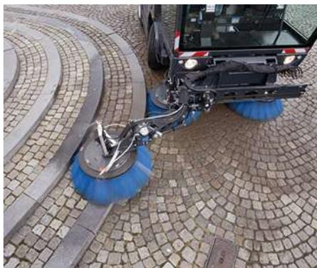
Mit dem optionalen dritten Besen kann die Arbeitsbreite auf 3.550 mm vergrößert werden. Dies ermöglicht eine grössere Flächenleistung und das Kehren auf zwei Ebenen.
