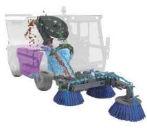
Das3-Besensystemmit frei bewegbarem Frontbesenarm bietet eine Kehrbreite bis zu 2.600 mm. Links-Rechts-Ausrichtung des Frontbesens ist genauso möglich wie Kehren auf zwei Ebenen oder schwerer Wildkrautbeseneinsatz.
