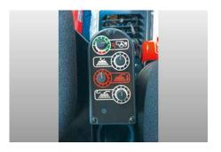
Die leichtgängige Lenkung mit in Höhe und Neigung verstellbarer Lenksäule, ein Tempomat, minimale Pedalkräfte, ein Gesundheitsfahrersitz mit AGR-Zertifikat ("Aktion Gesunder Rücken") sowie Bedien- und Kontrollinstrumente in optimalem Griffbereich runden die Leistungsmerkmale eines modernen, ergonomischen Arbeitsplatzes ab.
