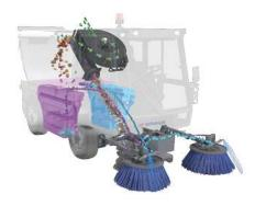
Das2-Besensystemgarantiert mit unabhängig voneinander steuerbaren Tellerbesen absolute Beweglichkeit in jeder Kehrsituation. Zwei stabile Besenarme mit integrierten Anfahrpuffern ermöglichen Kehrbreiten bis zu 2.900 mm.
