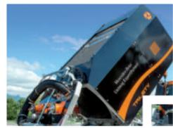
**Kehraggregat** montiert am Heck des Fahrzeuges, pneumatisch anhebbares Führungsparallelogramm mit automatischer Verriegelung, Pendelrahmen samt Saughaube mit Verschleißschutzbeschichtung, autom. Grobschmutzaufnahmeklappe, Saugschlauch 220mm und Stützrädern 250 mm, 2 seitlich schwenkbare, hydraulisch angetriebene Tellerbesen, 900 mm, mit stufenloser Drehzahlverstellung.
