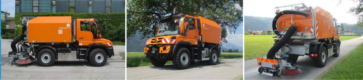
**Schmutzbehälter** aus Edelstahl (nach DIN 1.4301) Inhalt 3,0 - 4,2 m<sup>3</sup>, Beobachtungsklappe hinten in der Heckklappe, hydraulische Betätigung der Entleerungsklappe, Grobschmutzgitter und Abluftgitter öffnen bei Betätigung des Schalters gemeinsam. Schmutzwasserablass inkl. Storz "B" Kupplung. Schüttblende aus Gummi im verzinktem Rahmen unter der Behälteröffnung. Abluft nach oben. Grundrahmen mit Kugelaufnahmen inkl. Aufnahmevorrichtung für die Abstellfüße.
