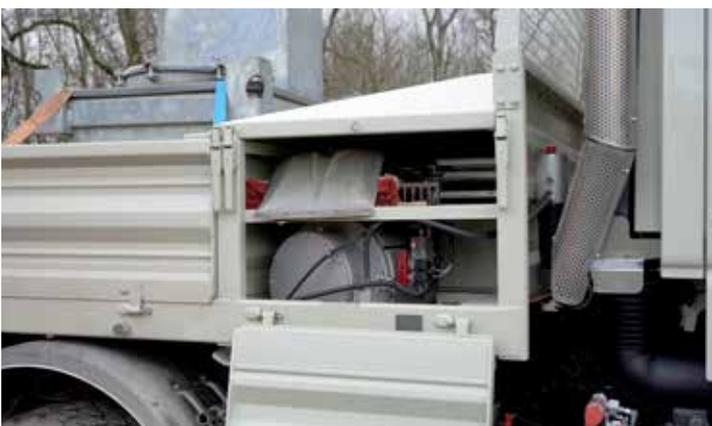
Einbau der Seilwinde in die schnellwechselbare 3-Seiten-Kipppritsche.
