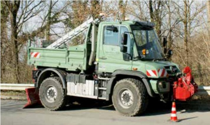
Durch den direkten Aufbau auf den Fahrzeugrahmen wird kein zusätzlicher Hilfs- oder Zwischenrahmen benötigt. Somit sitzt die Pritsche auf Höhe der original erhältlichen Pritsche. Die Arbeitshöhe erhöht sich nicht.
