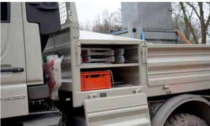
Die Pritsche mit eingebauter Seilwinde verfügt zusätzlich über eine große Werkzeugbox, die seitlich und nach oben geöffnet werden kann.
