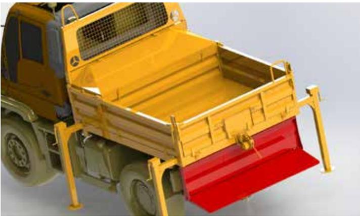
Schnelle und einfache Demontage der Wechselbrücke mit Seilwinde zum Aufbau anderer Arbeitsgeräte.
