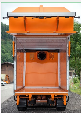
Innenansicht des Mähgutanhängers mit hydraulischem Pressschild
