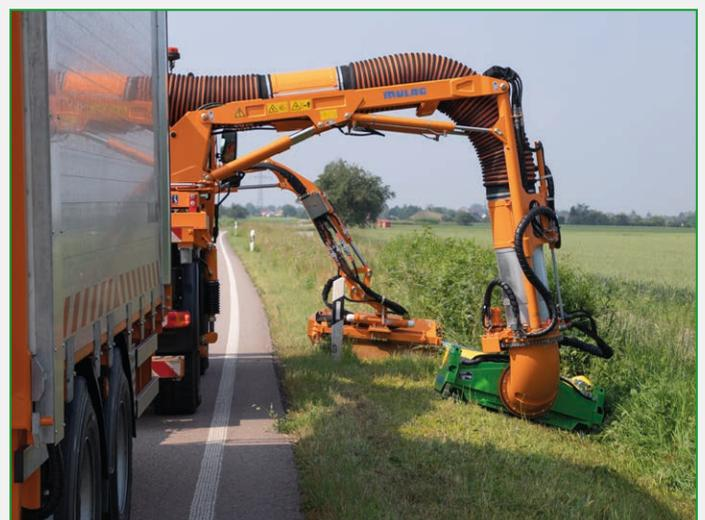
Große Reichweite – Heckauslegermähergerät SB 600 mit ECO 1200 plus
