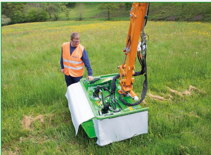
Ausklappen der Aufschiebvorrichtung am ECO 1200
