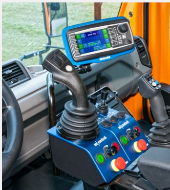
Kombinationsbedienung beider Mähgeräte mit einem Joystick
