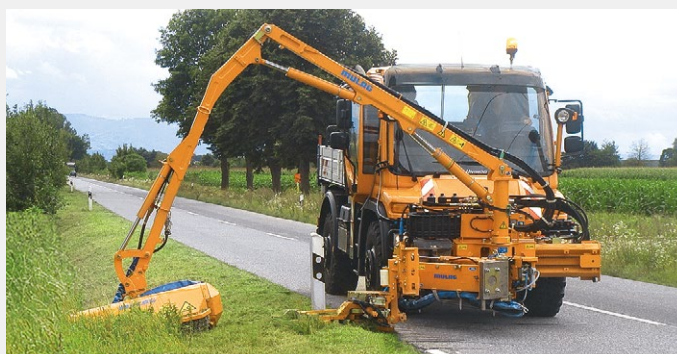
2. Durchfahrt mit Frontausleger-Mähgerät und Leitpfostenausmäher
