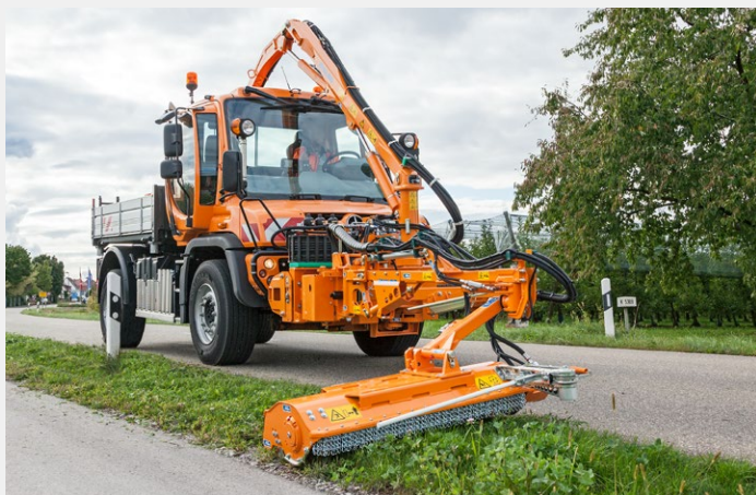
Solobetrieb mit Randstreifen-Mähgerät
