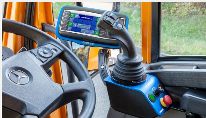
Kombinationsbedienung beider Mähgeräte mit einem Joystick
