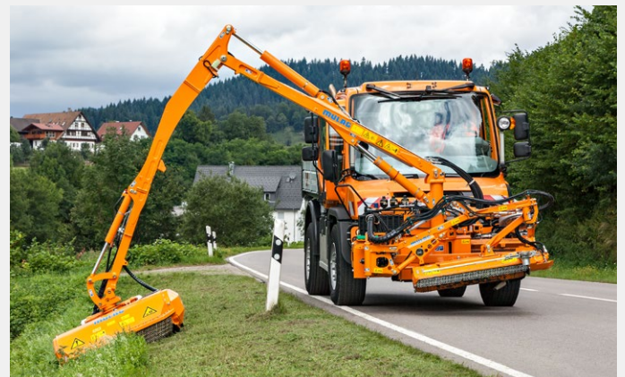
Solobetrieb mit Frontausleger-Mähgerät
