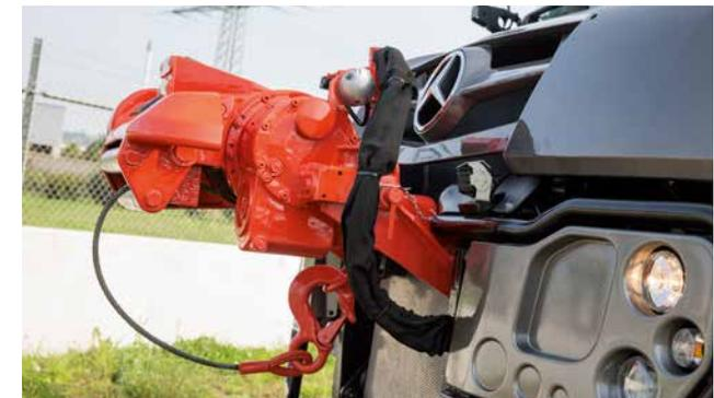
Standardisierte Schnittstellen und Anbaupunkte: Für beide Unimog Baureihen sind leistungsstarke Front- und Heck-Anbaueilwinden von Gerätepartnern verfügbar.
