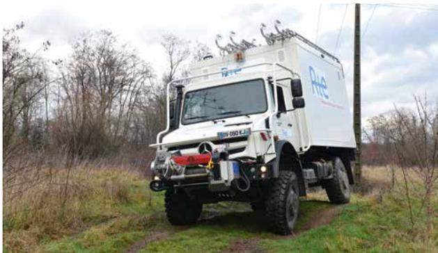
Mobile Werkstatt fürs Grobe: Mit dem Werkstattkofferaufbau sind kleine und große Reparaturen an Ort und Stelle möglich.
