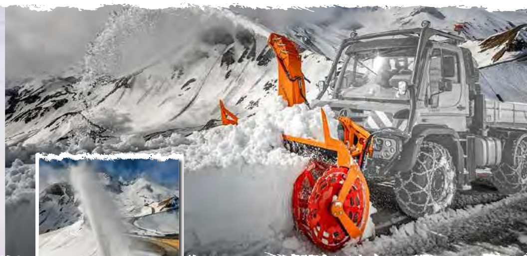
Durchschwenkbare Wurfradgehäuse (optional) Swivelling impeller housing (optional)
