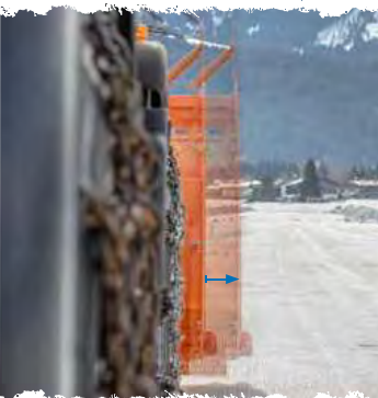
HYDRAULISCHER SEITENVERSCHUB HYDRAULIC LATERAL SHIFT
