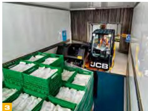
**3** Da kein Hubmast die Sicht nach vorn blockiert, können Sie dank der Vorwärtsreichweite des seitlichen Teleskopauslegers Fahrzeuge präzise be- und entladen sowie den verfügbaren Raum optimal ausnutzen.
