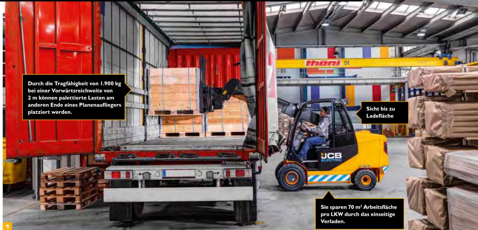
Durch die Tragfähigkeit von 1.900 kg bei einer Vorwärtsreichweite von 2 m können palettierte Lasten am anderen Ende eines Planenauflegers platziert werden.
