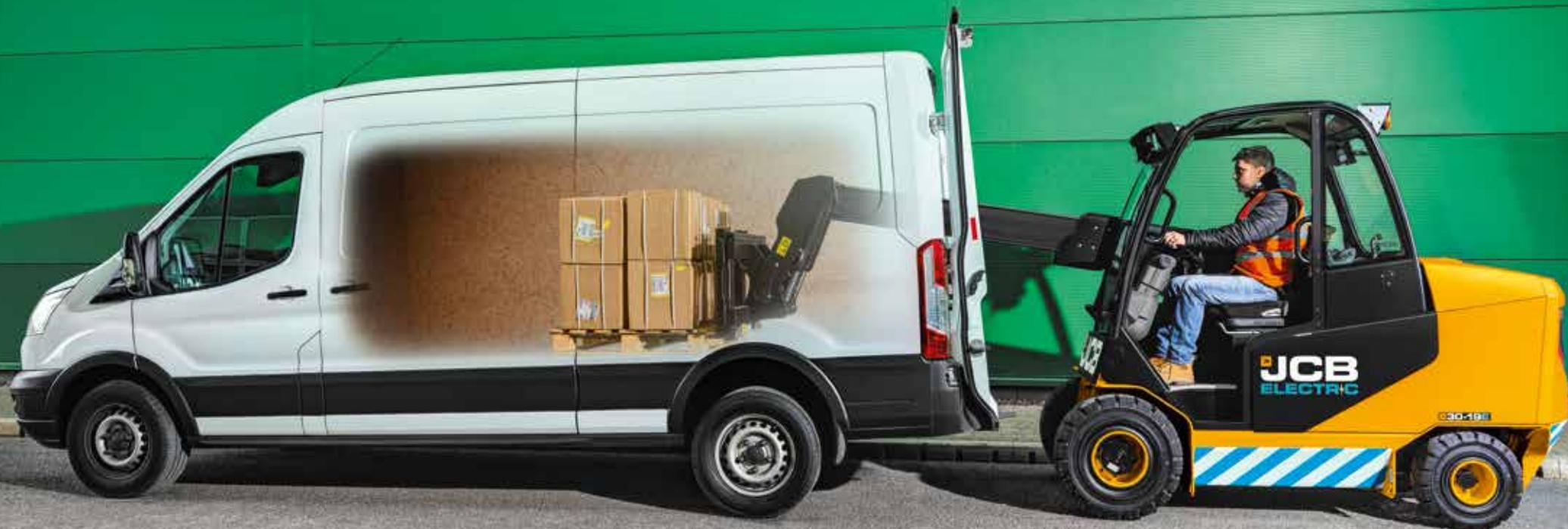
Die einzigartige Vorwärtsreichweite des Teleskopauslegers am Elektro Teletruk ermöglicht die Lieferwagen-, LKW-, Container- und Bahnverladung und unterstützt alle Arten von Logistikvorgängen.
