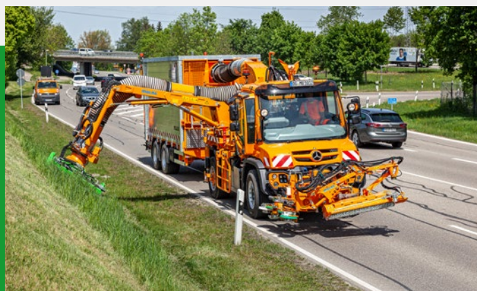
Grünpflegekopf ECO 1200 plus im Einsatz an einer Böschung
