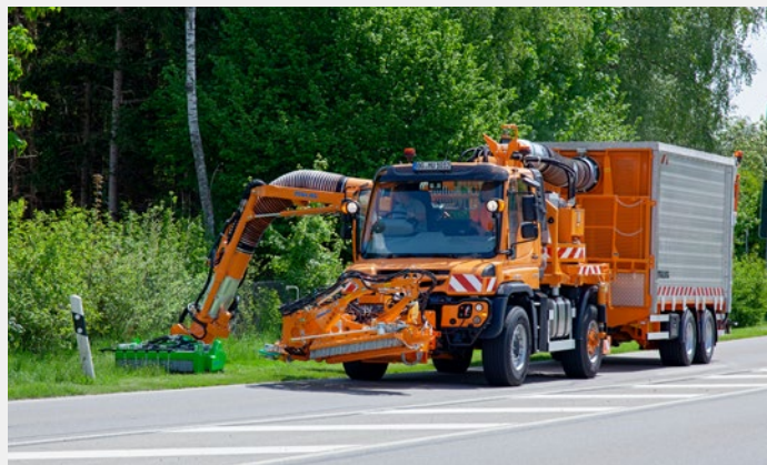
Heckausleger SB 600 mit angebautem Grünpflegekopf ECO 1200 plus
