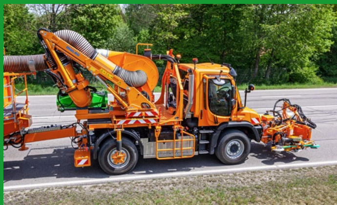
Transportstellung SB 600 mit Grünpflegekopf ECO 1200 plus
