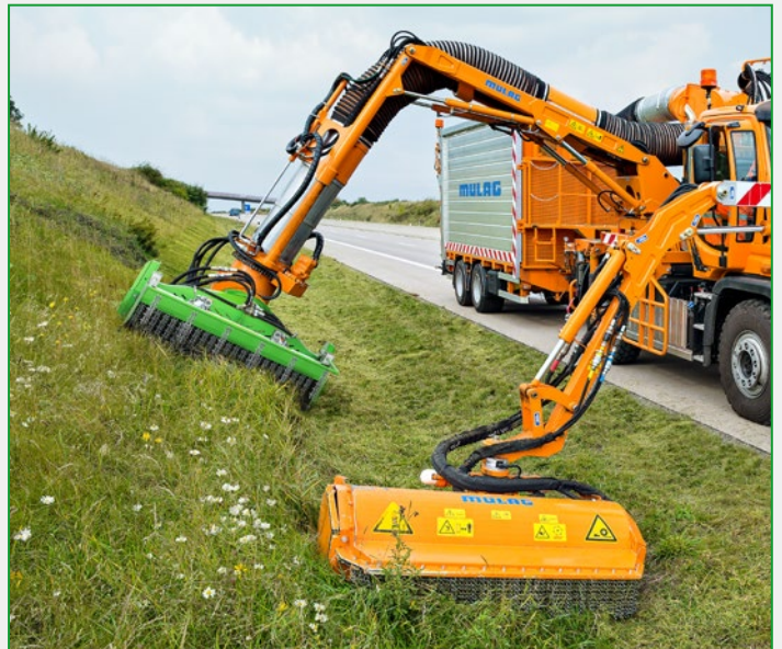
Kombinationseinsatz mit Schlegelmähkopf für den Intensivbereich
