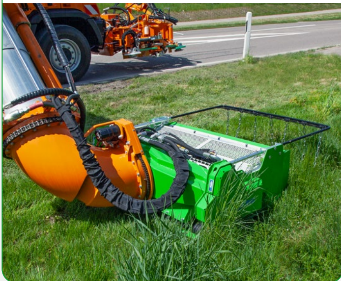
Kombinationseinsatz mit Schlegelmähkopf für den Intensivbereich
