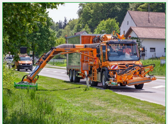
Große Reichweite – Heckauslegermähergerät SB 600 mit ECO 1200 plus
