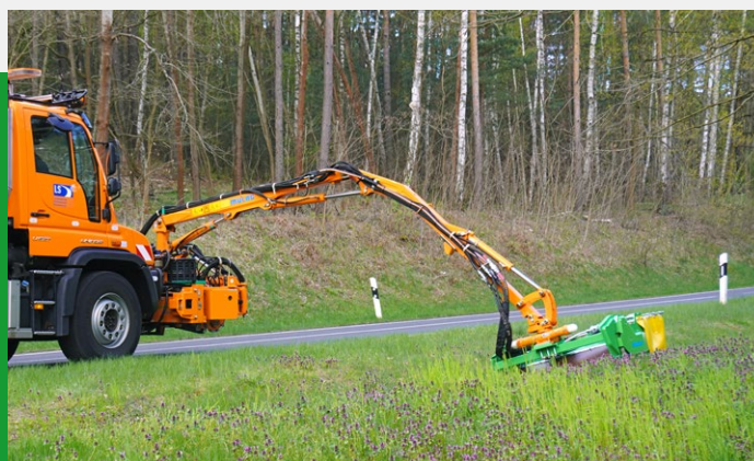
Grünpflegekopf ECO 1200 im Einsatz im Extensivbereich
