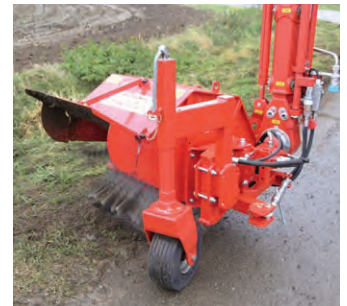
RWB 600 Radialwildkrautbürste Arbeitsbreite: 600 mm Rotordrehzahl: 150 U/min Gewicht: 320 kg
