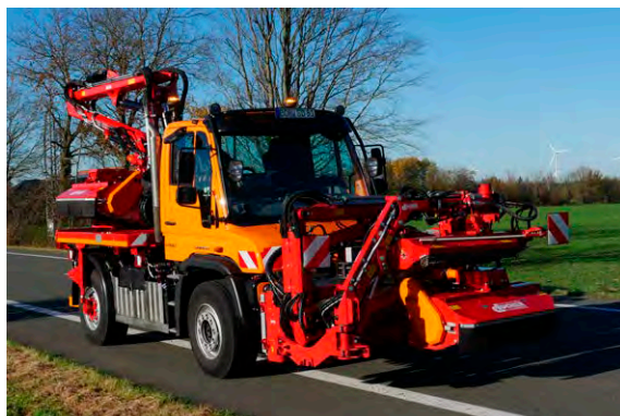
DAM als Mähkombination in Transportstellung
