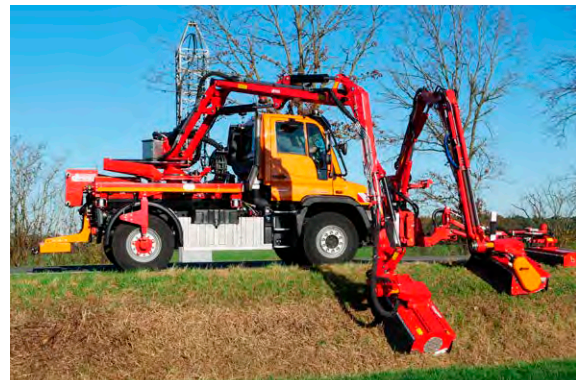
Die Mähkombination mit drei Mähköpfen ermöglicht die Mäh von 3 Schnitten in einem Arbeitsgang
