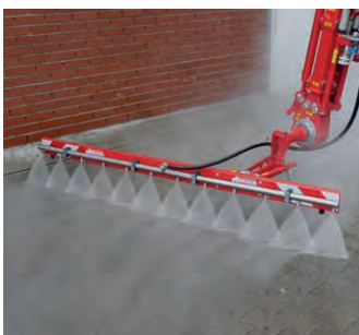
HDB 20 Hochdruck-Schwemmbalken Arbeitsbreite: 2000 mm Gewicht: 40 kg
