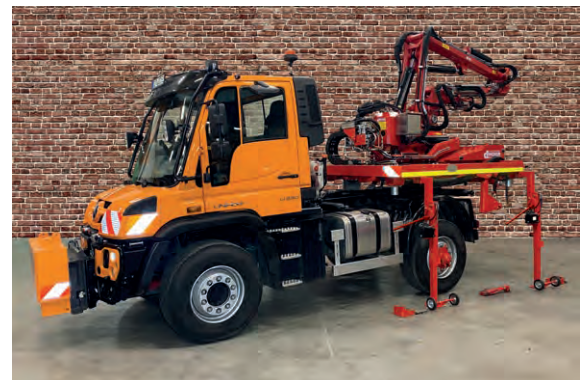
Einfache Demontage von Grundrahmen und Ausleger
