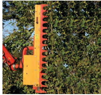
AWS 13 / 22 Ast- und Wallheckenschere Arbeitsbreite: 1300 / 2200 mm Schnittstärke: bis 110 mm Gewicht: ca. 160 kg / 230 kg
