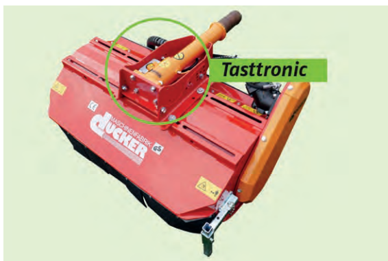
Mähkopf VMS 1200 mit integrierter Dücker-Tasttronic
