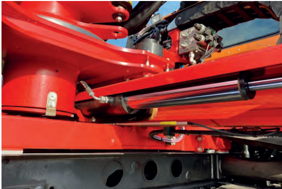
Verschiebung des Läufers über Hydraulikzylinder
