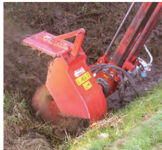
GSF 600 Grabensohlenfräse Fräsdurchmesser: 600 mm Rotordrehzahl: 800 U/min Gewicht: 230 kg
