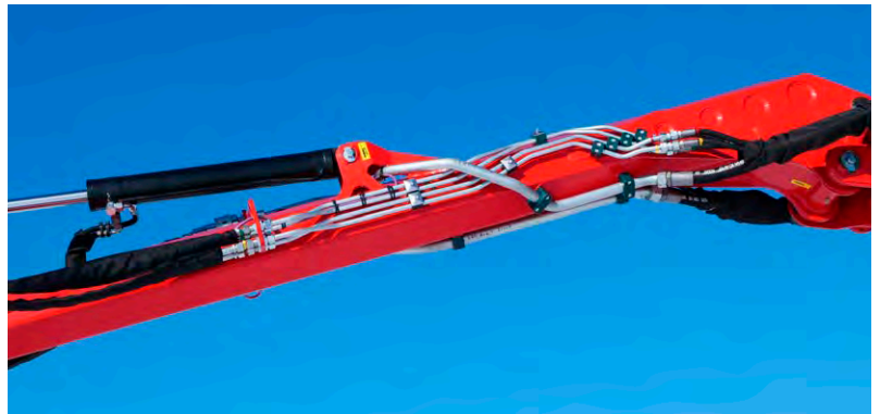
Fest verlegte Hydraulikleitungen aus Stahl
