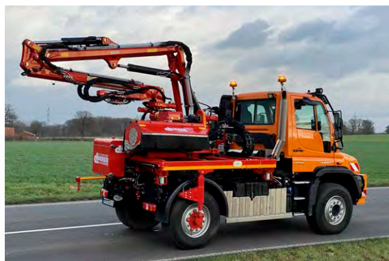
Transportstellung des Aufbauauslegers DAM
