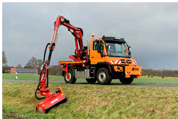
Der DAM 1050 beim Mähen einer Böschung
