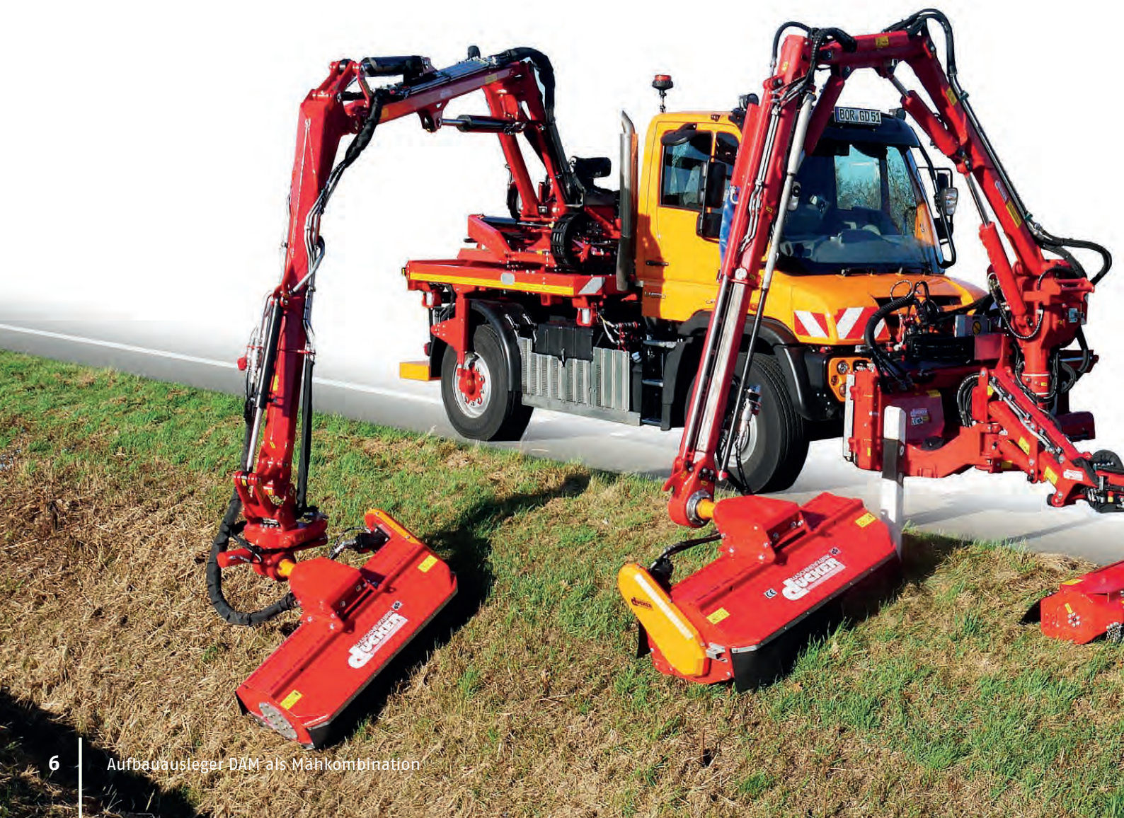
Die Mähkombination mit drei Mähköpfen ermöglicht die Mäh von 3 Schnitten in einem Arbeitsgang
