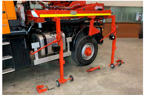
Auf Rollen fahrbare hydraulische Abstellstützen
