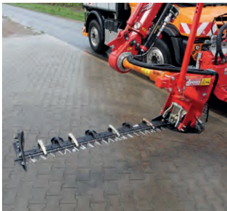
DMW 15 Doppelmesserschneidwerk Arbeitsbreite: 1500 mm Gewicht: 110 kg
