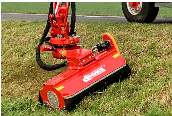
Geräteanbindung mit 2-achsiger Drehvorrichtung
