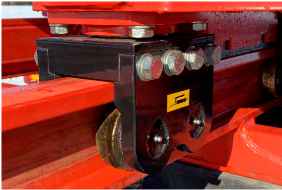
Der Läufer ist auf kugelgelagerten Rollen verschiebbar
