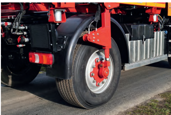
Achsabstützung des Grundrahmens
