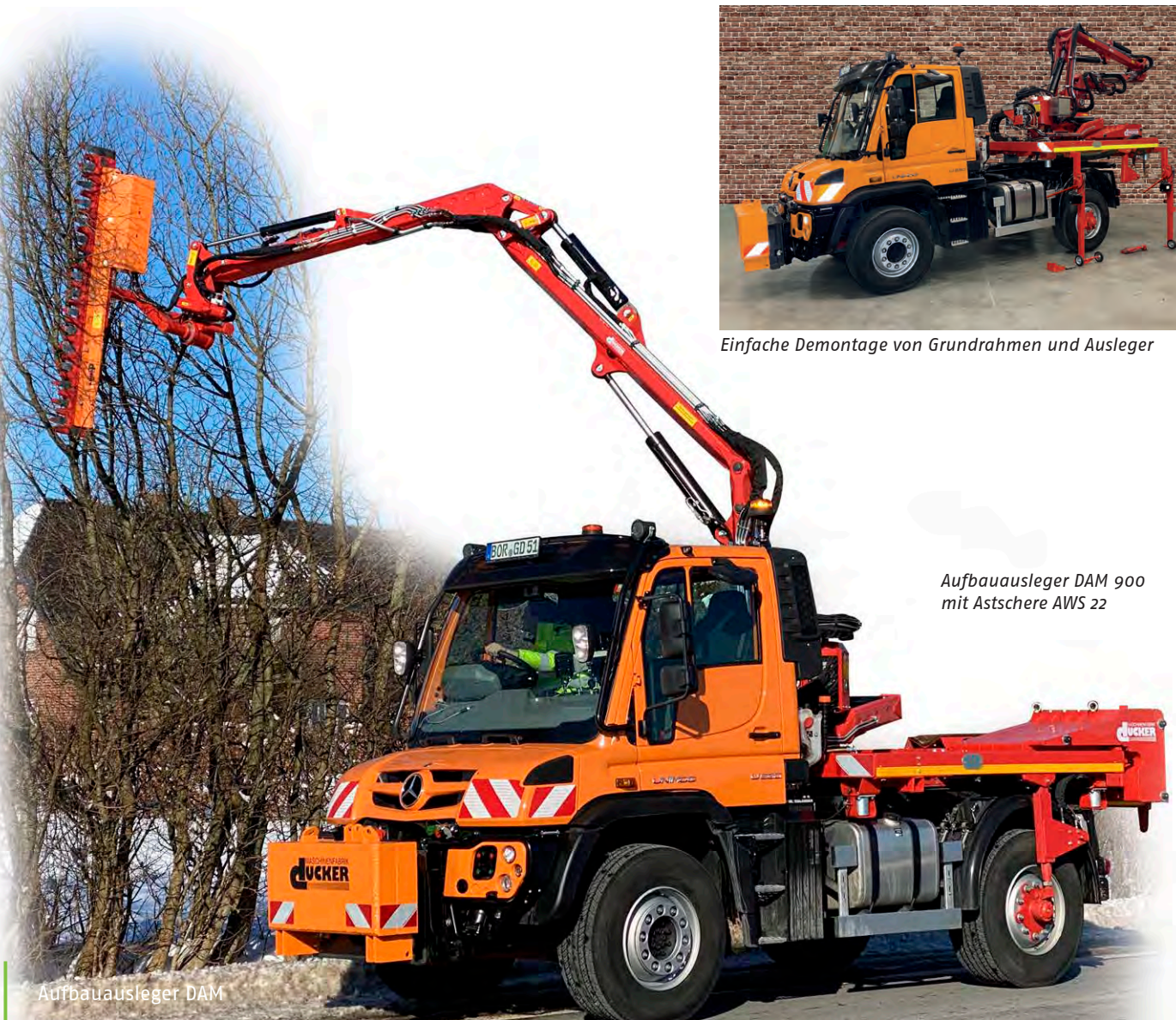
Der Aufbau auf den Pritschenzwischenrahmen mit werkzeugloser Verriegelung ermöglicht eine einfache Montage
