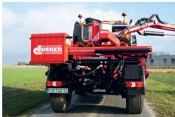
Das hydraulisch verschiebbare Gegengewicht
