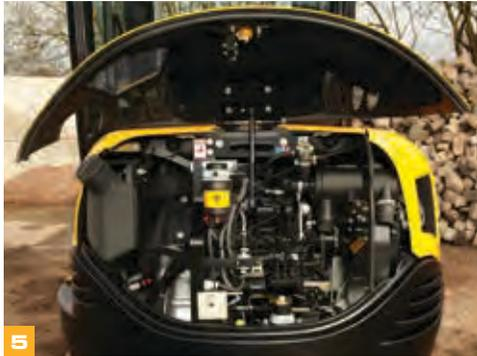
Unser neuer Hydraulikventilblock erlaubt das Geradeausfahren bei gleichzeitiger Auswahl von Baggerfunktionen für mehr Produktivität.
