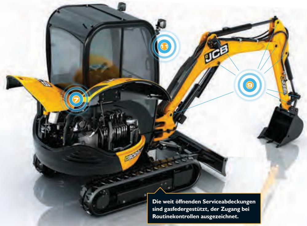
Die weit öffnenden Serviceabdeckungen sind gasfedergestützt, der Zugang bei Routinekontrollen ausgezeichnet.
