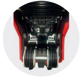
Der aus zwei Schlauchpaketen mit jeweils 3 Schläuchen bestehende Block verhindert das gegenseitige Aufscheuern und Verwickeln der Schläuche, was ebenfalls zu einer drastischen Schadensreduzierung beiträgt. Die Gleitschlitten sind an den Stahlblöcken befestigt und stellen die geschmeidige Bewegung der Konstruktion sicher.
