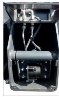
Automatische Erfassung der Konfiguration der Stützen durch Potentiometer, die zum Schutz vor Beschädigungen in den Holmen untergebracht sind.
