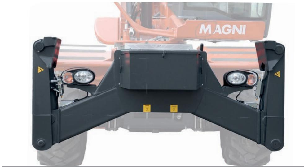
Die kompakte Bauweise des Chassis wird durch die auf derselben Achse angeordneten Klappstützen ergänzt, die sich im eingeklappten Zustand innerhalb der Fahrzeugkontur befinden und die Bodenfreiheit nicht beeinträchtigen. Bei ausgeklappten Stützen weisen diese eine kompakte Abstützbreite auf und garantieren dennoch eine hohe Hubkraft.
