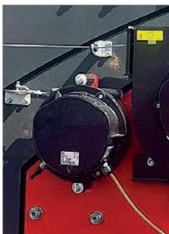
Potentiometer zur Erfassung des Winkels und der Länge des Auslegers mit doppelter Sicherheit.
