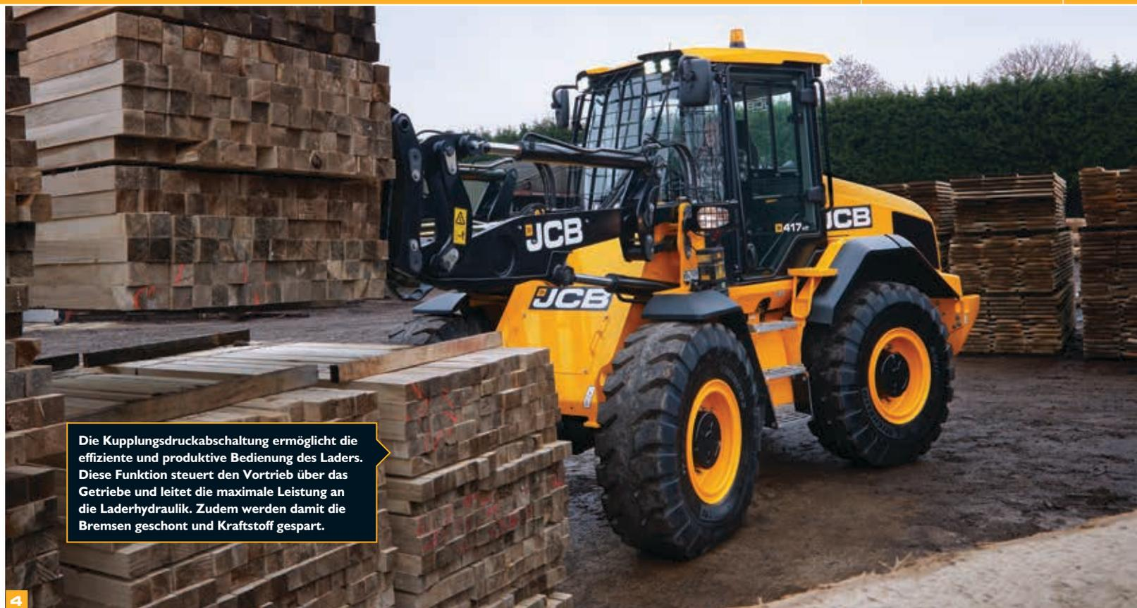
Die Kupplungsdruckabschaltung ermöglicht die effiziente und produktive Bedienung des Laders. Diese Funktion steuert den Vortrieb über das Getriebe und leitet die maximale Leistung an die Laderhydraulik. Zudem werden damit die Bremsen geschont und Kraftstoff gespart.
