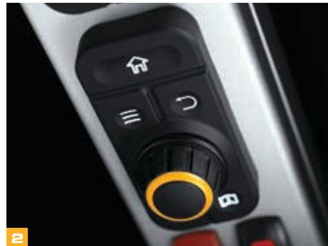
**2** Die einfachen, dedizierten Menüs der Maschine bedienen Sie optional mit einem intuitiven Drehschalter.
