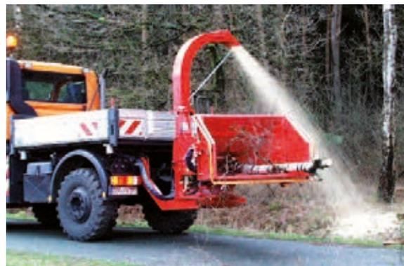
H 200, hydraulisch angetrieben vom Unimog
