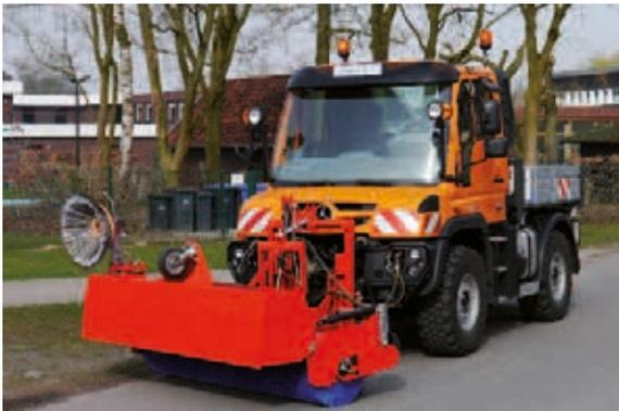
FKM, hydraulisch angetrieben vom Unimog
