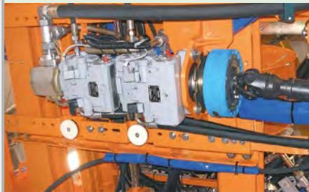
Der Antrieb für die Heckmähgeräte kann alternativ über den Motornebenantrieb Code N05 erfolgen. Das Mähgerät ist dadurch hydraulisch völlig unabhängig vom Trägerfahrzeug.
