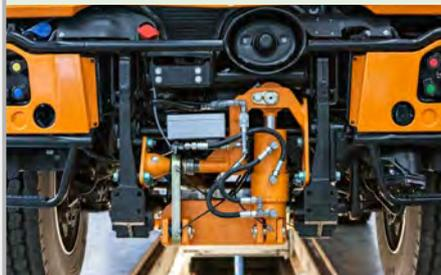
Vom Fahrerhaus zuschaltbare hydraulische Vorderachsverriegelung, die eine Fahrzeugverwindung (einseitige Einfederung) während des Mähbetriebs verhindert. Ein weiteres Sicherheitsplus für den Bediener.
