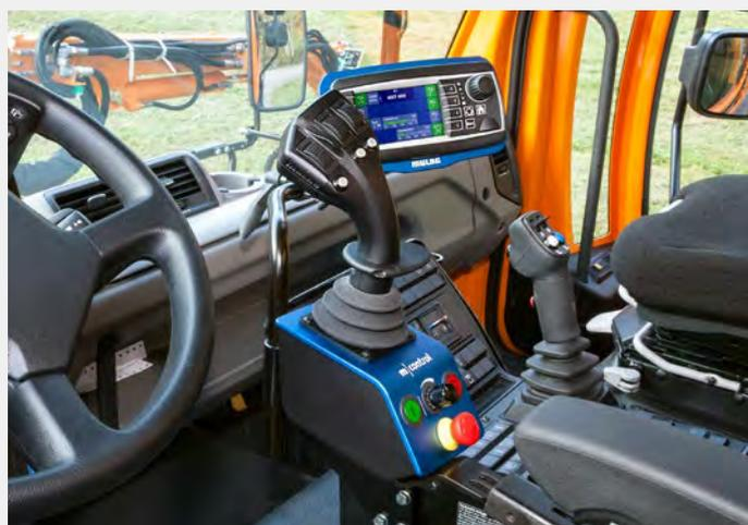
Multifunktions-Joystick m|pilot mit 6-facher Proportionalsteuerung
