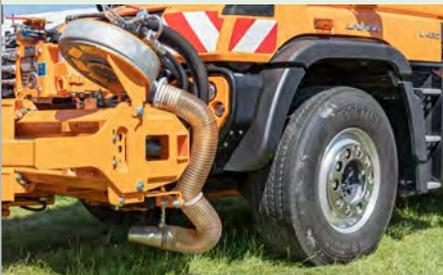
Das HDG dient zur Reinigung der Fahrbahn und bläst Schnittgut und Unrat effektiv an den Fahrbahnrand, bzw. ins Bankett. Alternativ kann das HDG auch an den CA4-Anbaubeschlägen des Unimog montiert werden.
