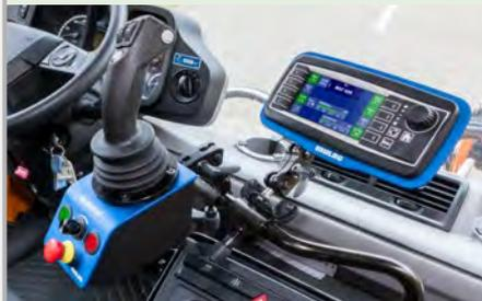
Die Passform dieses Bedienteils ist ergonomisch optimal auf die Handform des Menschen abgestimmt. Es sind bis zu vier Proportionalfunktionen auf einer Ebene steuerbar.
