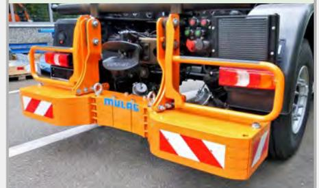
Ein von MULAG entwickeltes Ballastgewicht mit spezieller Formgebung ist auch für den Kombinationsbetrieb mit aufgebautem Streuautomaten geeignet.
