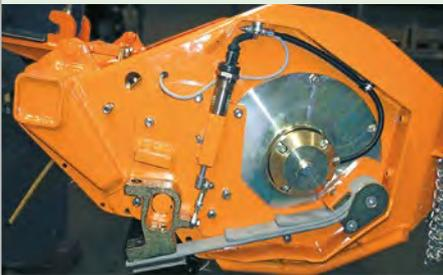
Vollautomatisch wirkende Auflagedruckregelung des Messerkopfes. Sensoren geben den Geländeverlauf an einen Zentralrechner. Dieser steuert die Auslegerfunktionen selbstständig.
