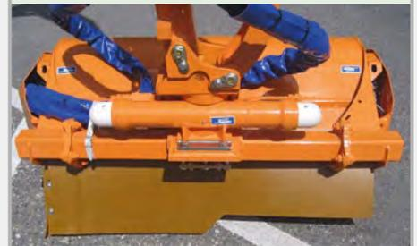
Der Verstellbereich beträgt 230 Grad und ist stufenlos über das Bedienpult steuerbar. Die Verstellung kann während des Arbeitsvorgangs erfolgen und ist variabel einstellbar.
