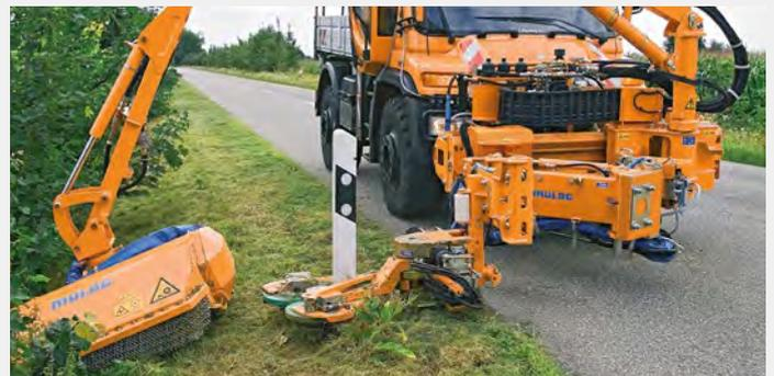
Leitpfostenausmäher im Wechselanbau am Kombinations-Mähgerät
