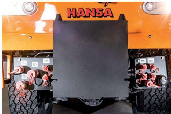
Massive Frontanbauplatte mit Parallelführung // Massive front mounting plate with parallel guide
