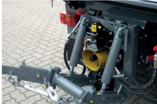
Heck-3-Punkt Aufnahme mit leistungsstarker Zapfwelle // 3-point rear pick up with powerful PTO shaft
