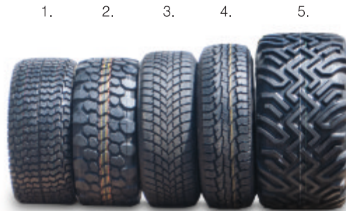
REIFEN // Tires 1. 315 / 55 R 16 Rasenprofil // Lawn profile 2. 315 / 55 R 16 MPT 3. 285 / 65 R 16 4. 265 / 75 R 16 5. 440 / 50 R 17
