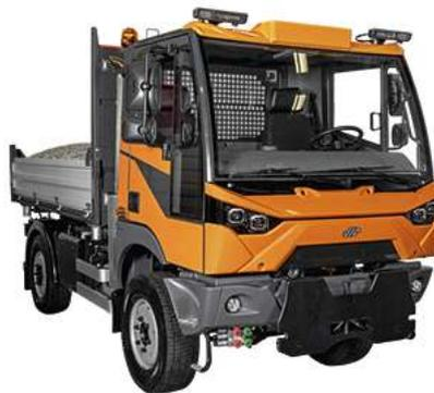
Die **maximale Nutzlast** von **4800 kg** und eine hydraulische Entlastung an der Fahrzeugfront machen den MT 770 zu einem zuverlässigen Partner für **anspruchsvolle Arbeiten**. Das **Gesamtgewicht** beläuft sich auf **7500 kg**.
