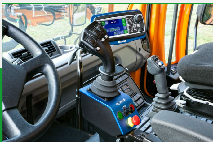
Bis zu 6 Proportionalfunktionen auf einer Ebene steuerbar!
