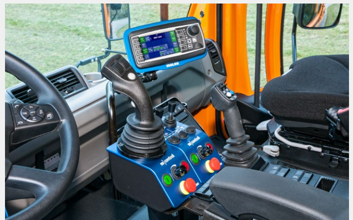
Ein-Mann-Mähgerätesteuerung von der Mittelkonsole aus
