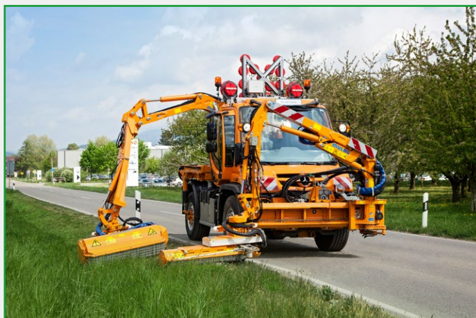
Komplexe Auslegersteuerung auch im Ein-Mann-Betrieb möglich
