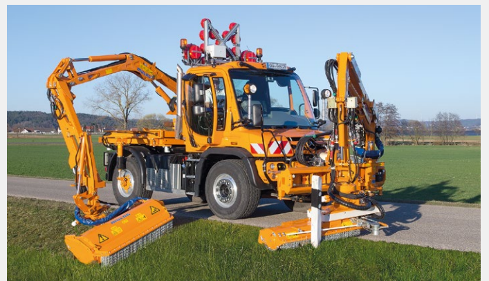
Mit m|pilot werden zwei Auslegermähgeräte mit einem Joystick steuerbar
