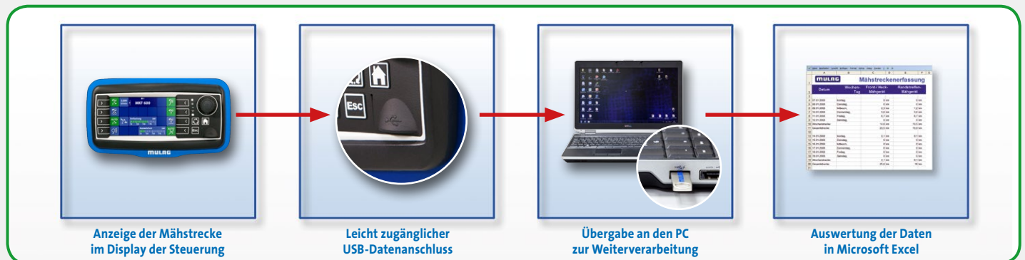
Grundfunktionen des MULAG-Systems zur Wegstreckenerfassung
