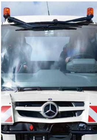
**Für beste Sichtverhältnisse: die oben angeordnete Scheibenwischeranlage.** Damit der Fahrer selbst im dichten Schneegestöber jederzeit den Durchblick behält, sind die Scheibenwischer beim Unimog oben angeschlagen. Der Vorteil: Der Schnee kann sich nicht im Blickfeld des Fahrers auf den Wischerblättern aufbauen.
