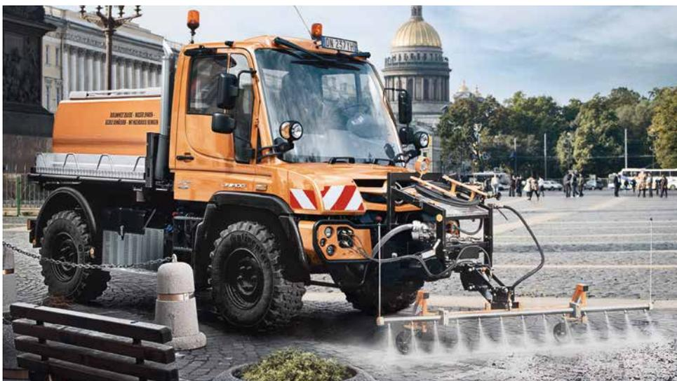
**Von Autobahnbaustelle bis Innenstadt:** Der Unimog hat auf zahlreiche Reinigungsanforderung die passende Antwort. Frontkehrbesen halten beispielsweise Baustellenbereiche sauber, Hochdruck-Reinigungsbalken entfernen Staub und Schmutz flächendeckend schnell und effektiv und Spezialgeräte wie Tunnelwascher ersetzen eine ganze Flotte an Spezialfahrzeugen.
