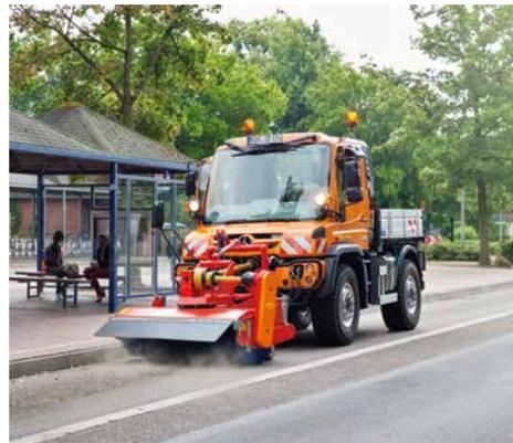
**U 319 / U 323 / U 327: der Dauerläufer für kleine und mittlere Städte.** Mit einer Motorleistung von 140 kW (190 PS)/200 kW (272 PS), einem zulässigen Gesamtgewicht von 11,0 bis 14,0 t und allen Ausstattungsoptionen eines Profi-Geräteträgers erfüllt der Allrounder alle wichtigen kommunalen Anforderungen. Damit ist das Modell die richtige Wahl, beispielsweise für kleinere Kommunen.
