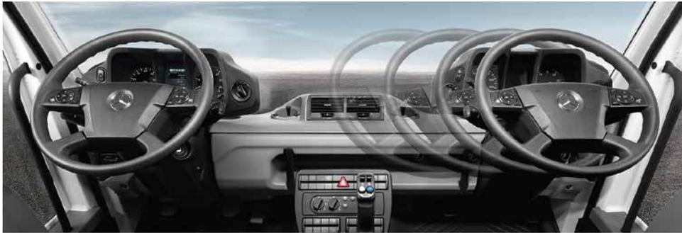
**Entspannte Mäheinsätze: Wechsellenkung VarioPilot®.** Für optimale Übersicht über den Fahr- und den Arbeitsbereich zugleich integriert der Unimog optional die praktische Wechsellenkung VarioPilot®. Sie erlaubt dem Fahrer, je nach Arbeitseinsatz die Sitzposition auf die andere Fahrzeugseite zu wechseln.
