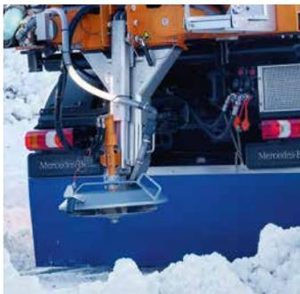
**Wehrt Salz und Sole ab: der Korrosionsschutz.** Als der Winterdienst-Profi schlechthin ist der Unimog bestens vorbereitet auf den Kontakt mit aggressiven Streusalzen. So sind Antriebsstrang und Fahrwerk sowie sämtliche Teile, die mit Taumitteln in Berührung kommen, wirkungsvoll vor Korrosion geschützt.
