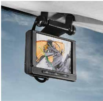
**Beste Rundumsicht: das Kamera-Monitorsystem mit bis zu drei optionalen Kameras.** Die Übersicht optimieren und zugleich das Ankoppeln von Geräten erleichtern – das sind die beiden wesentlichen Vorteile des optionalen Kamera-Monitorsystems. Die Kameras sind integriert in die Fahrzeugfront und in das Heck. Zusätzlich ist eine frei positionierbare Aufbau-/Gerätekamera erhältlich. Das Bild wird auf einem Monitor im Innenraum dargestellt.
