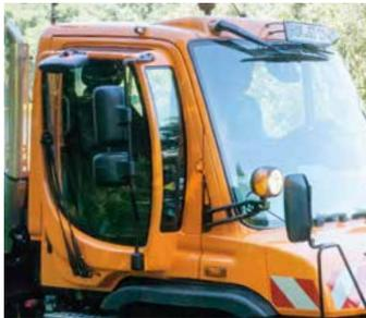
**Den Arbeitsbereich im Fokus: Mähtür und Drehsitz.** Besonders produktiv sind Mäheinsätze mit dem Triomäher im Zwei-Mann-Betrieb. Eigens dafür gibt es die Sonderausstattung Mähtür inklusive eines drehbaren Beifahrersitzes. Beste Sicht auf den Arbeitsbereich ist so garantiert.
