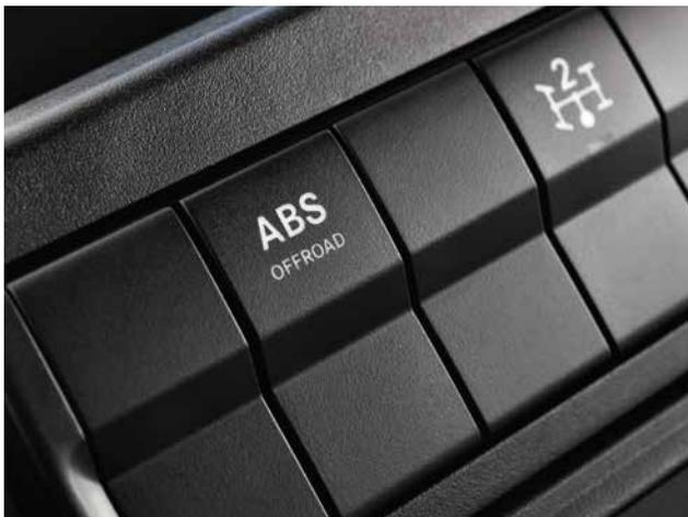
4-Kanal-ABS an Bord: Sicheres Fahrverhalten beim Bremsvorgang sorgt für Stabilität und Lenkfähigkeit durch separates Ansteuern jedes Rades.
