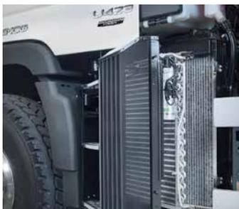
**Weniger Unterbrechungen: das wartungsfreundliche Kühlsystem.** Der Unimog macht die Reinigung des Kühlers ganz leicht: einfach Gitter öffnen und mit der Druckluftpistole ausblasen. Der Kühler kann auch automatisch gereinigt werden – mit dem optionalen Wendelüfter Cleanfix® mit Multitimer-Intervallsteuerung.
