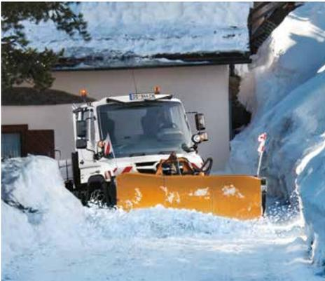
**U 219: Geräteträgerkompetenz für Dienstleister und Gemeinden.** Das kompakte Unimog Modell U 219 hat einen extrem kurzen Radstand von lediglich 2,8 m. Damit ermöglicht er die Arbeit überall dort, wo jeder Millimeter zählt. Mit 140 kW (190 PS) ist das Modell für fast jede Herausforderung ausreichend motorisiert und erfüllt mit drei verschiedenen Lastwerten von 7,5 bis 10 t vielfältige Aufgaben.
