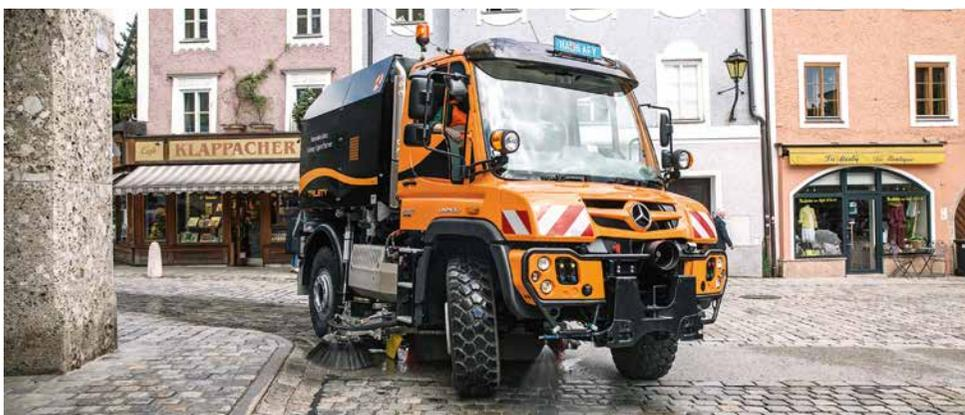
Mit der ab Werk lieferbaren Vorrüstung für Aufbaukehrmaschinen ist selbst ein Kehr-Aufbau in kurzer Zeit auf- und wieder abgebaut. Dabei ist der Unimog schnell für andere Aufgaben einsatzbereit.
