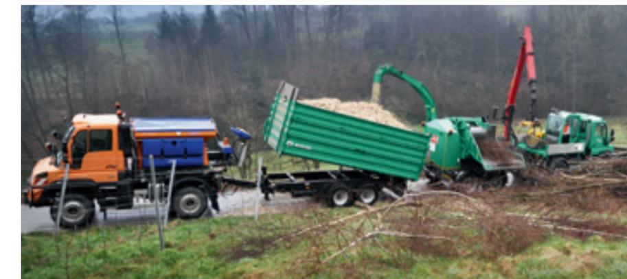
In der Übergangsjahreszeit kann der Unimog auch mit aufgebautem Streuer für andere Arbeiten wie z. B. Transport eingesetzt werden.
