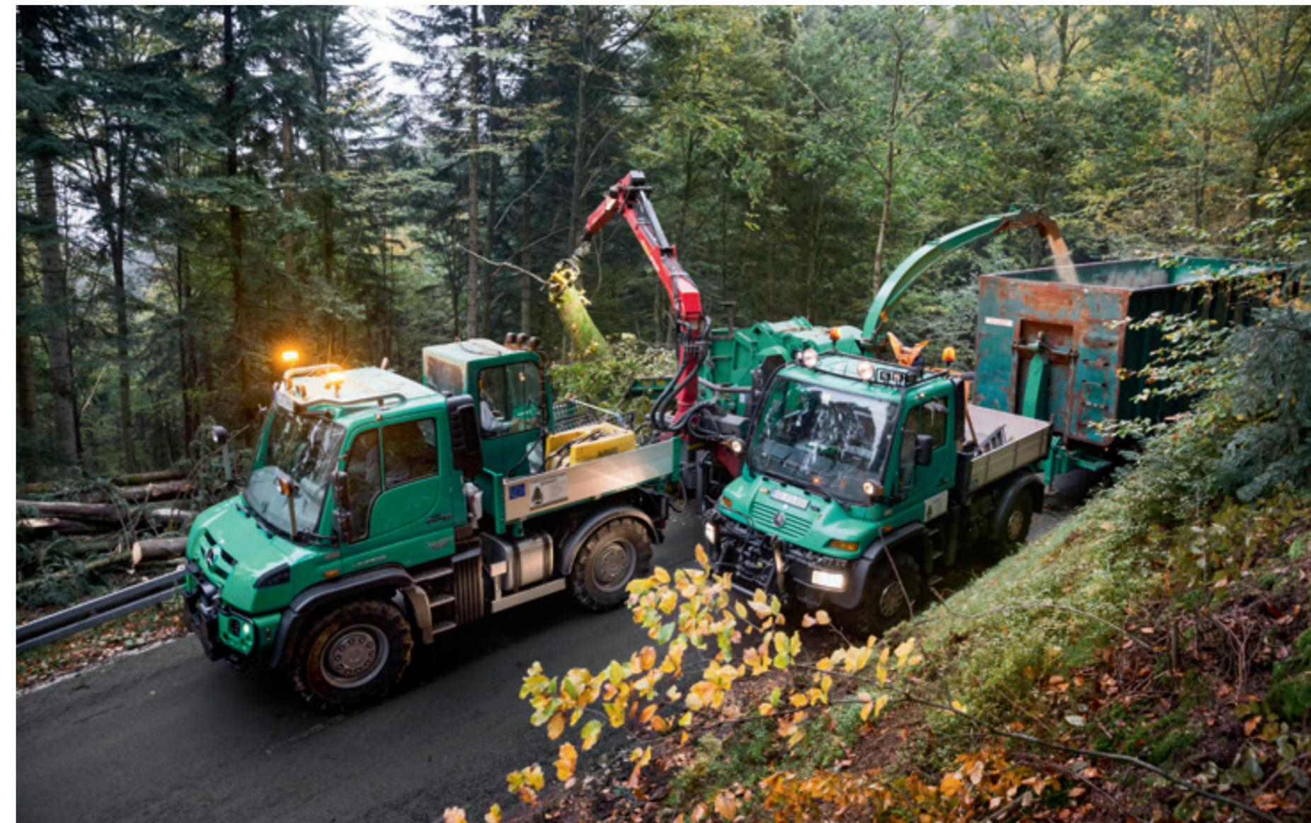
U 430 und U 400 bei der Energieholzgewinnung: voller Einsatz an der Heckzapfwelle, schnell und sparsam beim Transport.
