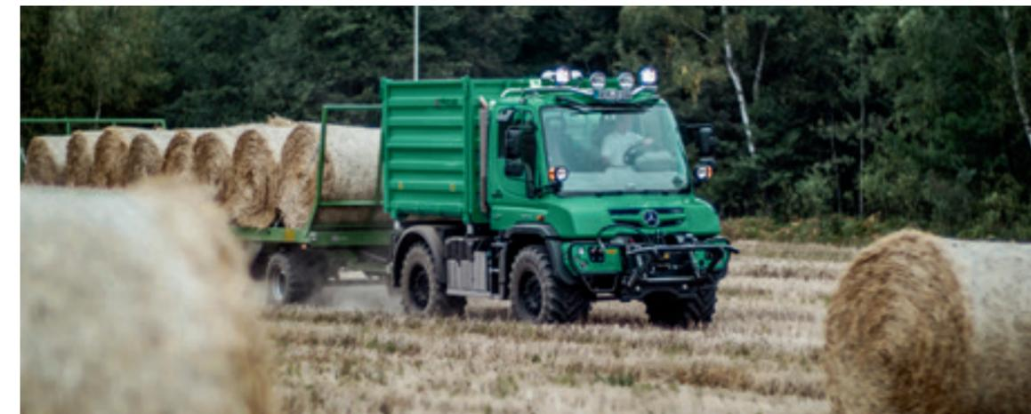
Bei landwirtschaftlichen Transporten kommt es auf eine maximale Nutzlast an. Deswegen ist der Unimog auf schwere Zuladungen und ein großes Transportvolumen ausgelegt. Mit dem geringen Leergewicht für eine hohe Nutzlast bis 25 t bei einem Gesamtzuggewicht bis 40 t bringt der Unimog starke Argumente für eine wirtschaftliche Agrarlogistik mit.
