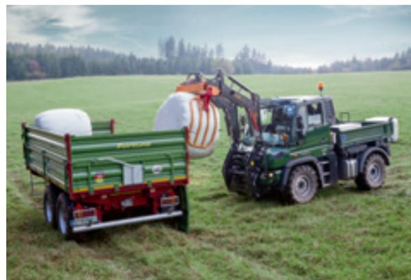
Beste Sicht bei Ladearbeiten: der Unimog mit Frontlader.
