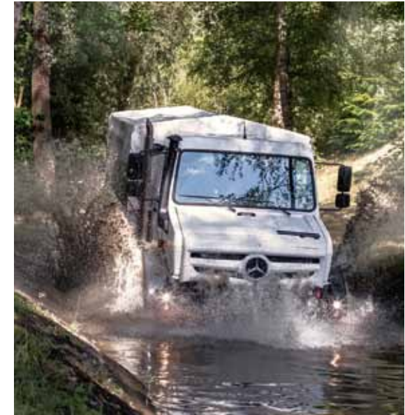
Wasserfest: Große Bodenfreiheit, hochgezogener Ansaugkamin und geschützte Aggregate für Wadtiefen bis zu 80 cm (optional 120 cm).
