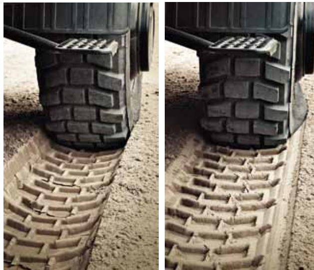
Prinzip Single-Bereifung: Die Hinterräder folgen den Vorderrädern in einer Spur. Das erhöht die Traktion und schont den Untergrund.
