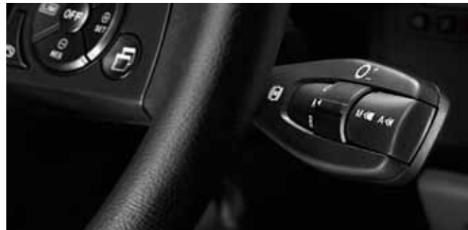
Die richtige Untersetzung auf Knopfdruck: komfortables Schalten mit dem Lenkstockschalter.
