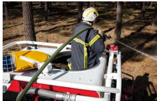
Brandbekämpfung durch die ab Werk verfügbare Dachluke.
