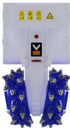
Die Stierkopffräsen der Serie KRC haben zwei winklig zueinander angeordnete Schneidköpfe, deren Hartmetallmeißel so dicht nebeneinanderstehen, dass in den meisten Gesteinen kein Mittelsteg entsteht, der durch seitliches Schwenken des Baggerarms entfernt werden müsste. So ergibt sich beim Arbeiten ein nahezu
