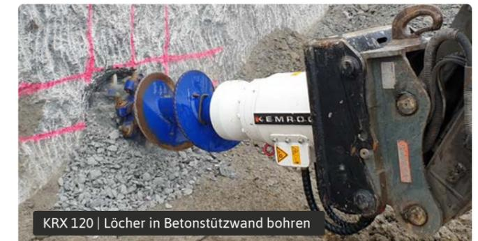
KRX 120 | Löcher in Betonstützwand bohren
