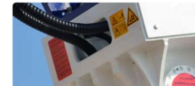
Spezielle Konsole zum Schutz der Hydraulikschläuche
